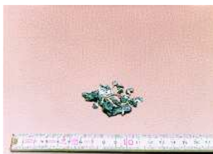
2. ábra: Salakképződés ugyanannyi idő alatt nitrogén atmoszférában
