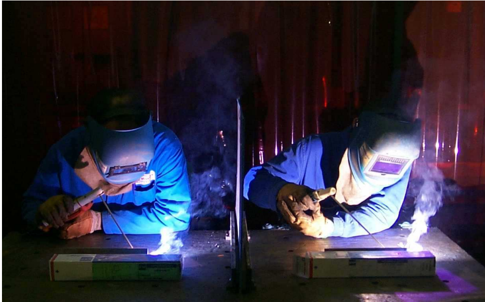
17. ábra: Füstképződés különböző elektródák használatánál ( balra: CRISTAL™ 316L, Ø3.2; balra: standard 316L, Ø3.2)
