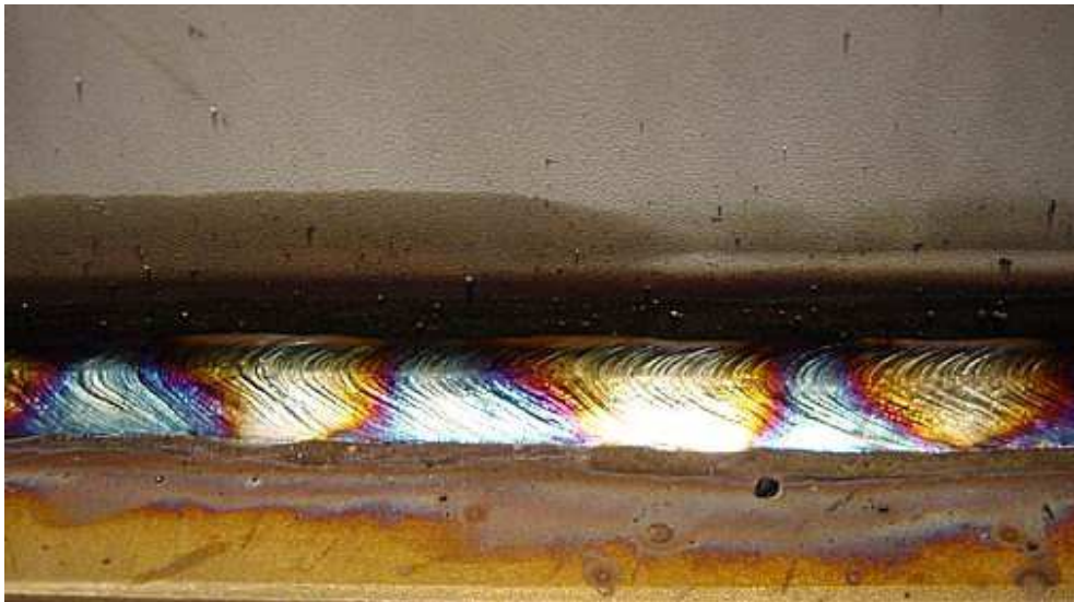
16. ábra: 316L típusú Ø3.2 mm átmérőjű standard elektródával hegesztett varrat
