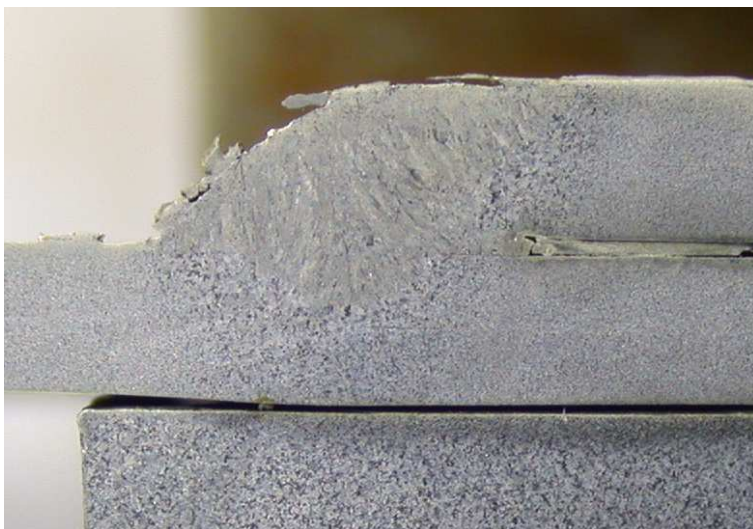
1. kép: 82%Ar + 18%CO 2 védőgáz, G3Si1 huzal kombinációval készített varrat keresztirányú makroszkópikus csiszolata
