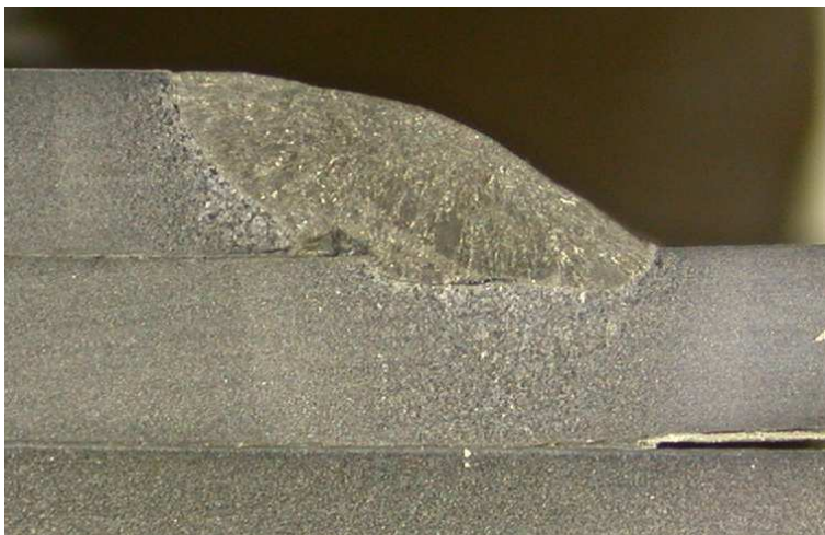
3. kép: 82%Ar + 18%CO 2 védőgáz, SAFDUAL ZN huzal kombinációval készített varrat keresztirányú makroszkopikus csiszolata
