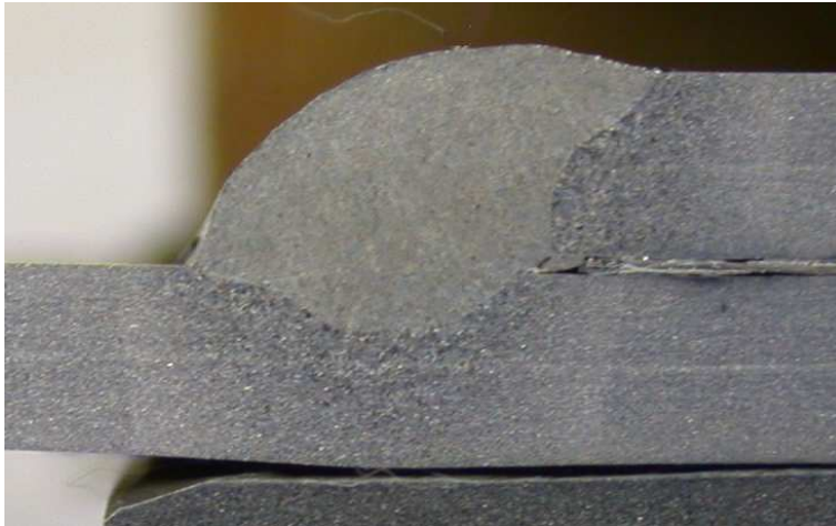
2. kép: 82%Ar + 18%CO 2 védőgáz, NERTALIC ZN huzal kombinációval készített varrat keresztirányú makroszkopikus csiszolata
